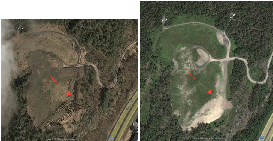
Figur 8. Flygbilderna visar Åseberget 2009. Vänstra bilden från mars och högra från juni samma år. I bilden från mars observeras vad som tolkas som schakthögar där markyta återställts i juni. Röd pil markerar område för schakthögar och återställd markyta. (Google Earth, 2022)
