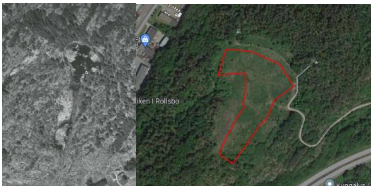
Figur 4: På flygfoto från 1963 till vänster, syns vad som kan förmodas vara resterna av Åsedammen centralt i utredningsområdet. Sträckningen stämmer även bra överens med de högsta halterna av metangas som uppmäts enligt figur 2. En ungefärlig utbredning av torvområdet har markerats på bilden till höger.
