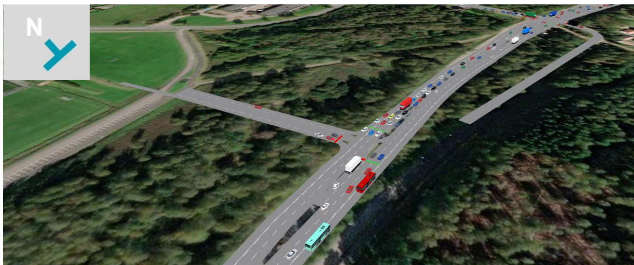
Figur 13 Resultat från simuleringen för år 2040 med hastigheten 70 km/h. Ny anslutning väster om Rollsbokrysset, precis omslaget till grönt i västlig riktning. Detaljplan för Arenan ligger i direkt anslutning till denna nya anslutning.
