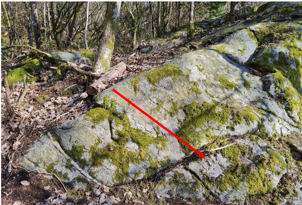
Figur 6. Fotografi av berghäll norr om Scoutkårens huvudbyggnad. Röd pil visar foliationsriktningen som stupar ca 40° åt sydöst vid denna håll.
