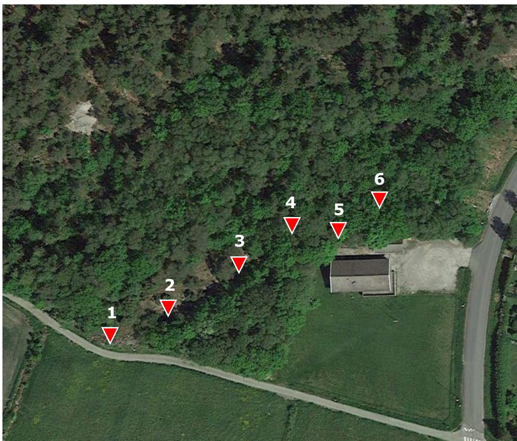
Figur 2. Närbild på området där ny skola och idrottshall planeras. Fastighetsgränser och förslag på planskiss visas i Figur 3. Punkt 1 – 6 visar ungefärlig placering där radonmätning på berg utförts.
