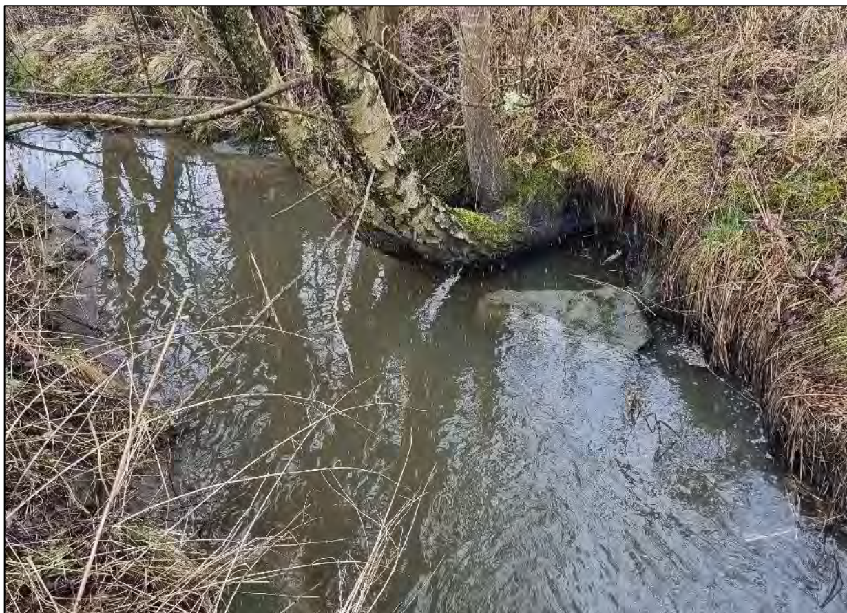
Figur 6-4 - Bild tagen längs vattendrag norr om fotbollsplanerna. Pågående erosion observeras i ytterkrön där växtlighet och jordmassor delvist har eroderats bort (Dec, 2022)
