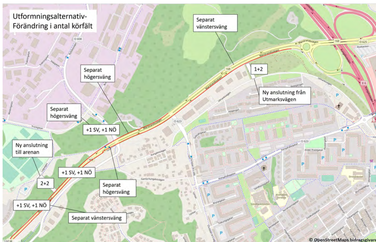
Figur 3 Undersökt utformningsalternativ inklusive förändring av antal körfält. Den södergående riktningen är presenterad först och de röda strecken representerar bussfiler.
