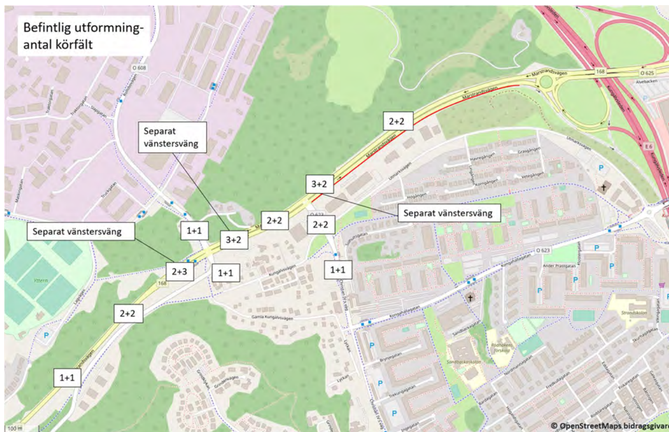
Figur 1 Befintlig utformning av trafiksystemet inklusive antal körfält. Den södergående riktningen är presenterad först och det röda strecket representerar ett kollektivtrafikkörfält i nordöstlig riktning.
