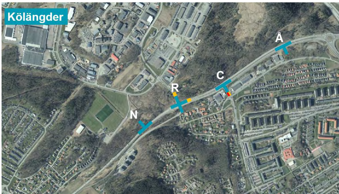
Figur 13. Korsningar där köbildningarna studerats. Orange markering visar det korsningsben där maxkö påverkar nästkommande korsning. Röd markering visar medelkö som påverkar nästkommande korsning.
