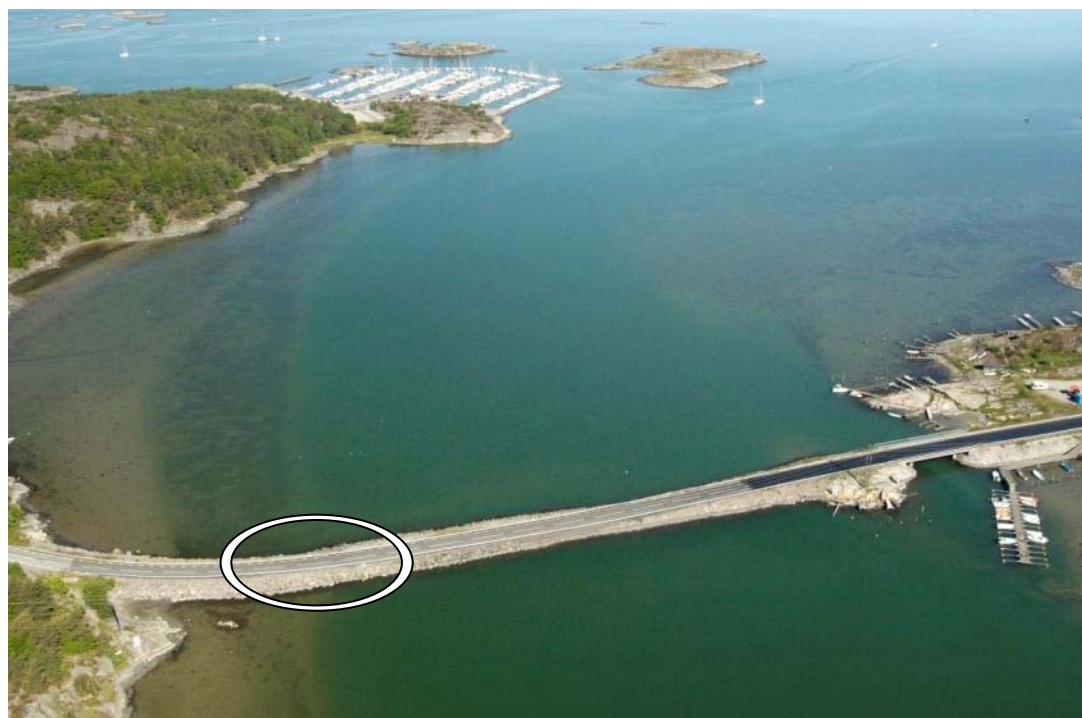
Figur 2, Flygfoto över sundet mellan Nordön och Tjuvkil (HydroGIS AB, 2009). Preliminär placering av trumma/trummor genom vägbank.
