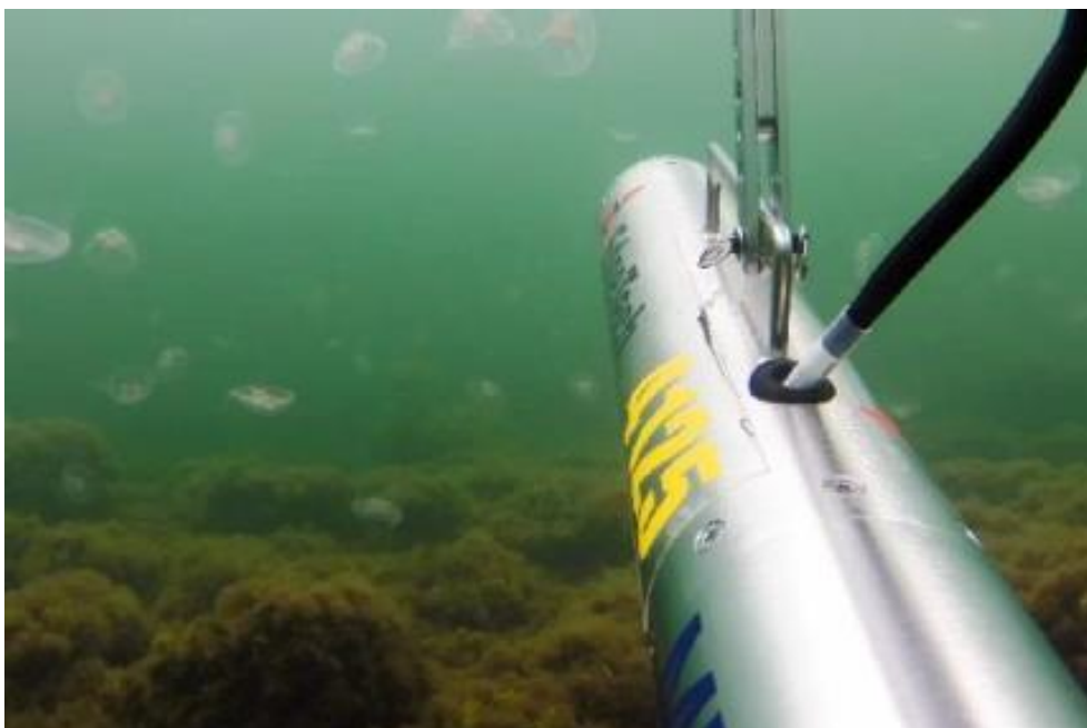
Figur 1. Det sonarsystem (EdgeTech 4125) som användes vid naturvärdeskarteringen utanför Fiskebäckens hamn 2023.
