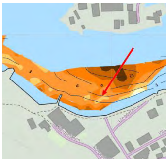
Figur 4. Djup- och Backscatterkartor (hårdhet) baserade på ekolodsdata från Marstrand 2016. Mörka färger i hårdhetskartorna indikerar mjukare botten. Medins Havs- och vattenkonsulter AB 2016.
