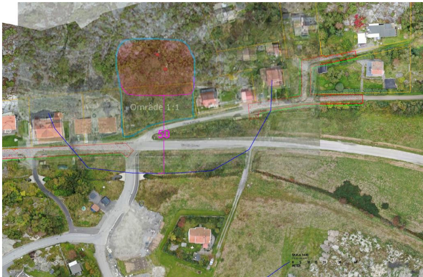
Figur 1. Område 1:1 är inringat i blått och observationspunkter visas i rött. Område där skrotning har rekommenderats är markerat i rött. Säkerhetsavstånd 50 m för sprängning är markerad med blå linje. Planerade VA-schakt är markerade med rött raster.
