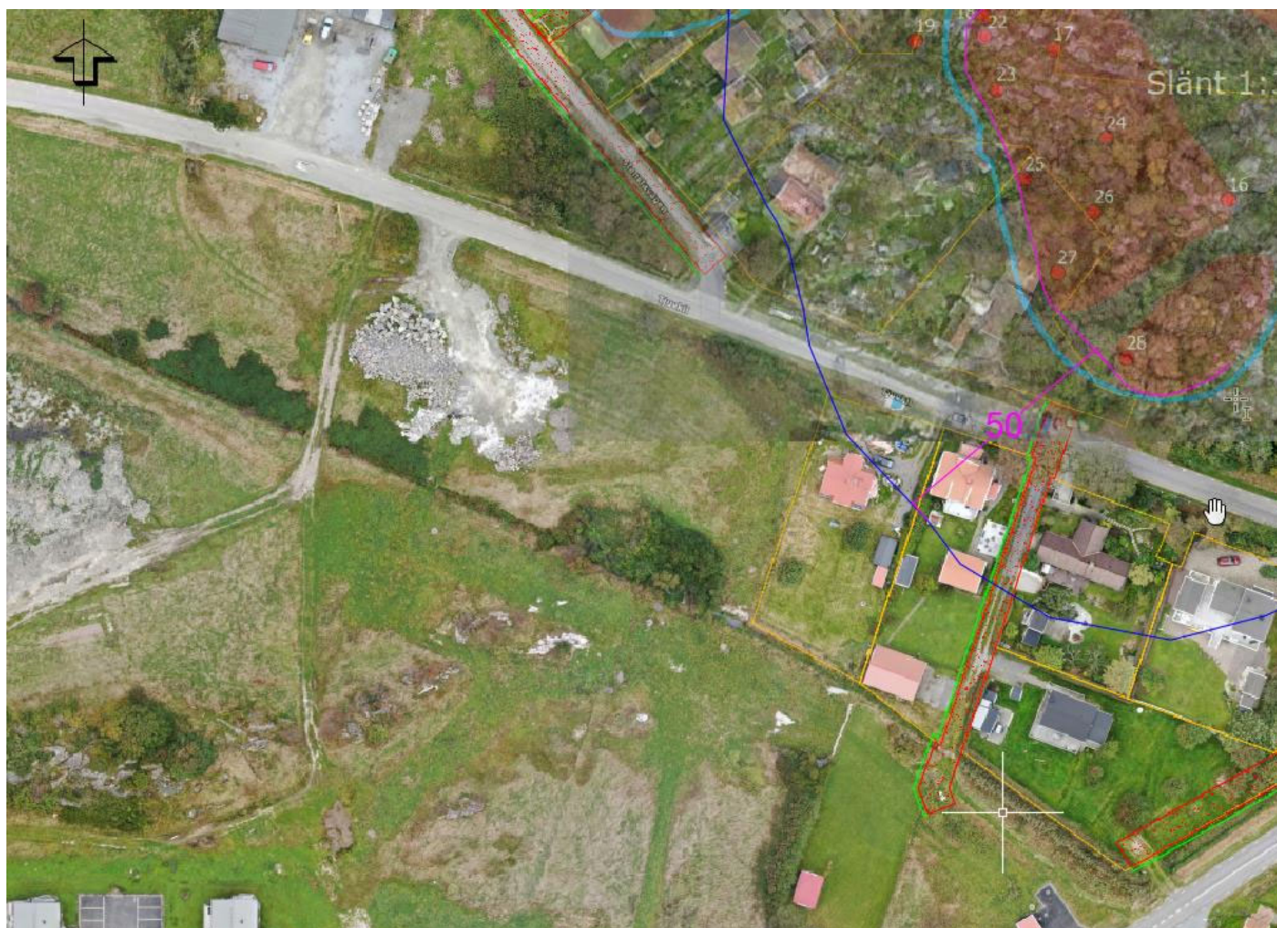
Figur 2. Område 1:3 är inringat i blått och observationspunkter visas i rött. Område där skotning har rekommenderats är markerat i rött. Säkerhetsavstånd 50 m för sprängning är markerad med blå linje. Planerade VA-schakt är markerade med rött raster.
