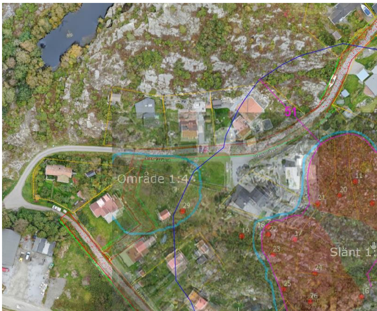
Figur 4 Område 1:4 och 1:2 är inringat i blått och observationspunkter visas i rött. Område där skrotning har rekommenderats är markerat i rött. Säkerhetsavstånd 50 m för sprängning är markerad med blå linje. Planerade VA-schakt är markerade med rött raster.
