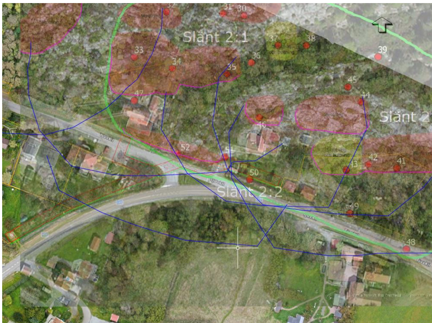
Figur 3 Område 2:1 och 2:2 är inringade i blått och observationspunkter visas i rött. Område där skrotning har rekommenderats är markerat i rött. Säkerhetsavstånd 50 m för sprängning är markerad med blå linje. Planerade VA-schakt är markerade med rött raster.
