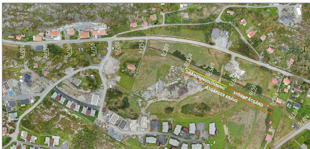
Figur 10. Längdmätning för Tjuvkilsdike från utlopp (0/000) till väg 168 (0/624). Markering av sträckan 0/350 till 0/550 där åtgärder krävs p.g.a. lösa markförhållanden.
