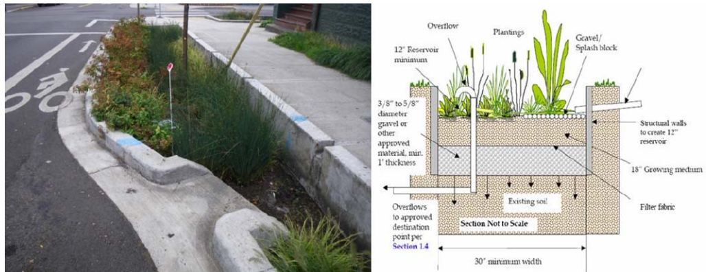
Figur 32 Nedsänkta planteringsutrymmen som bidrar till rening och fördröjning av dagvatten, så kallade kantstenslösningar eller biofilter.
