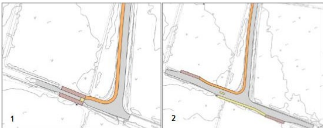
Till vänster (1): Föreslagen hållplatslösning ur Trafikutredning (Norconsult). Till höger (2): Alternativ utformning av hållplatslösning ur Trafikutredning. I utredningen rekommenderas alternativ 1. Norconsult
