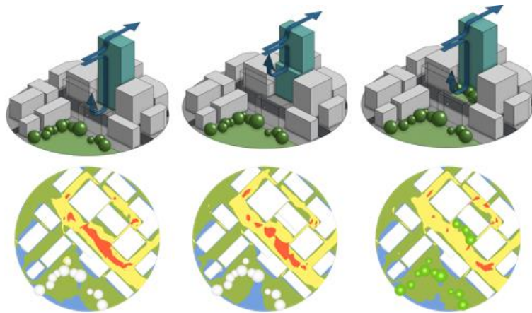
Figur 7. Effekten av en hög byggnad på vinden i gaturummet. Den övre bilden visar byggnadsutformning, och vindflöde (blå pilar). De undre bilderna representerar ytor med vindhastigheter över vissa tröskelvärden, där grönt representerar mindre blåsiga områden och rött visar mer blåsiga områden. Bild modifierad från Lynch (2023).
