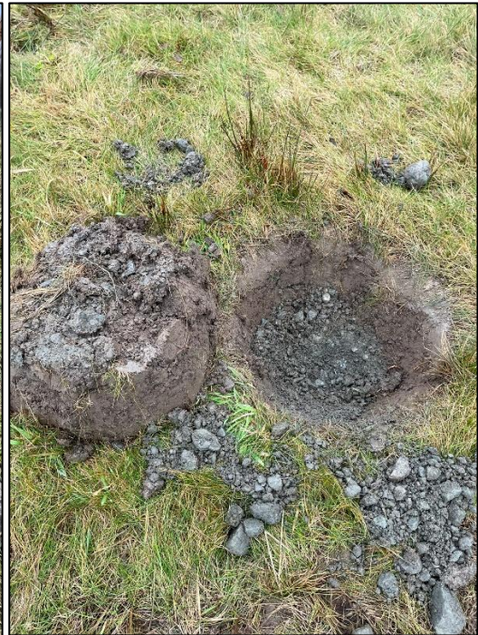
Figur 6. Provpunkt 4-B inom Delområde 4. Materialet utgörs av sandig mull ned till 0,2 m u my underlagrat av stenig, grusig sand
