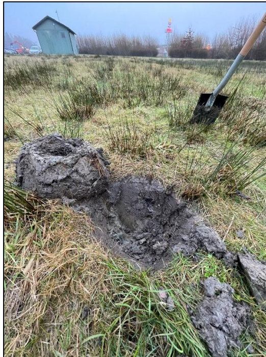
Figur 5. Provpunkt 5-B inom Delområde 5. Materialet utgörs av grusig, sandig mull ned till 0,3 m u my underlagrat av torrskorpelera
