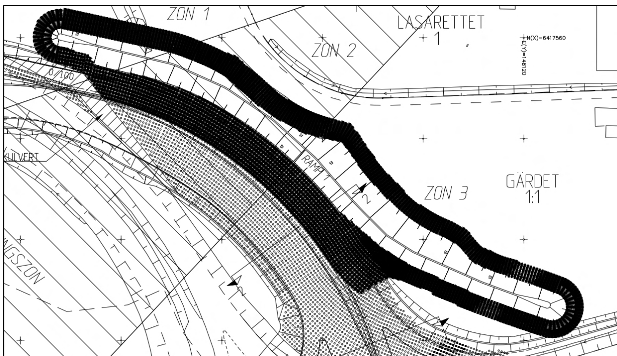
Figur 13-5 – Planritning över förstärkningsåtgärder (KC) intill diket (Trafikverket, 2016).
