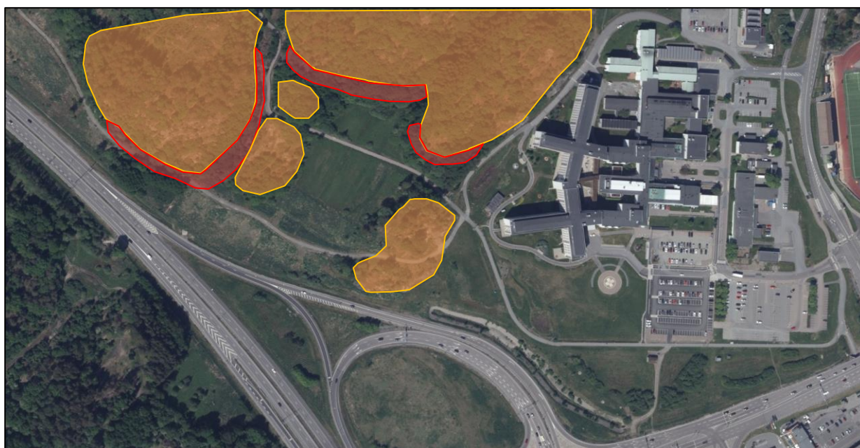
Figur 10-2 – Grovt markerade ytor med observerade blockutfall (röd) och berghällar/bergslänter (orange).
