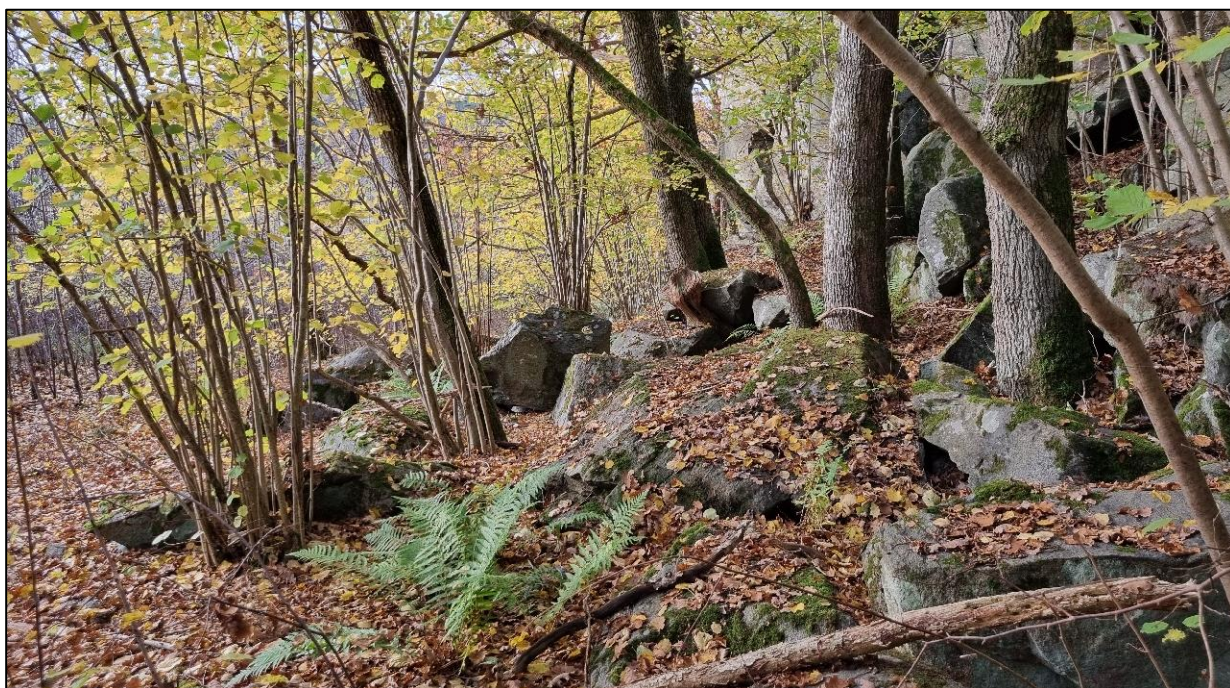
Figur 7-5 – Observerade blockutfall vid västra bergskärningen, ca 5 – 10 m ut från berget.
