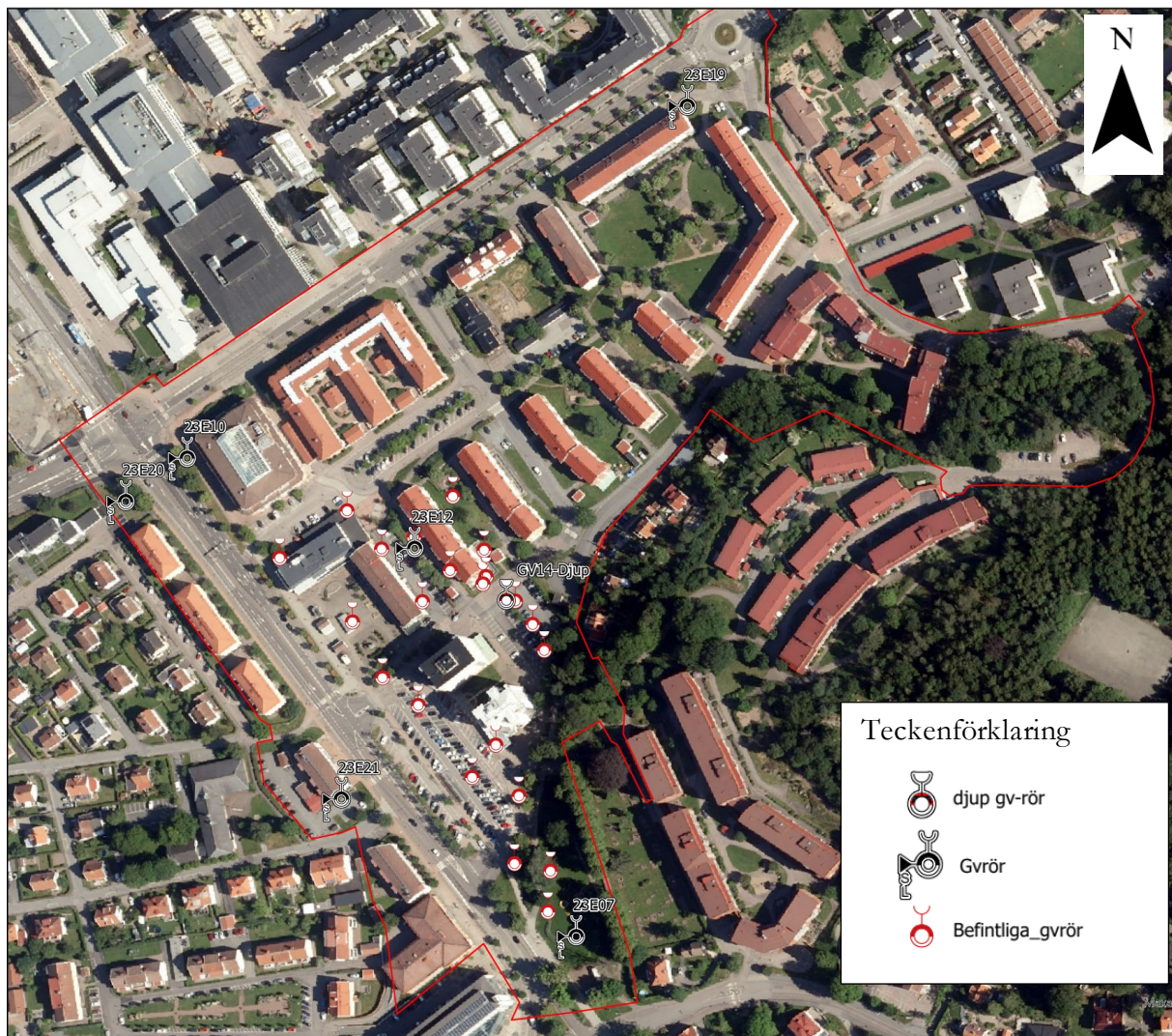
Figur 10. Grundvattenrör som provtagits inom ramen för aktuell undersökning återges med svart färg. Befintliga grundvattenrör som ej provtagits i samband med aktuell undersökning återges med röd färg. Benämningen GV indikerar grundvattenrör installerad i grundvattenmagasin och GV-djup är grundvattenrör som har installerats i friktionsjorden mellan berget och de mäktiga lerlagren.
