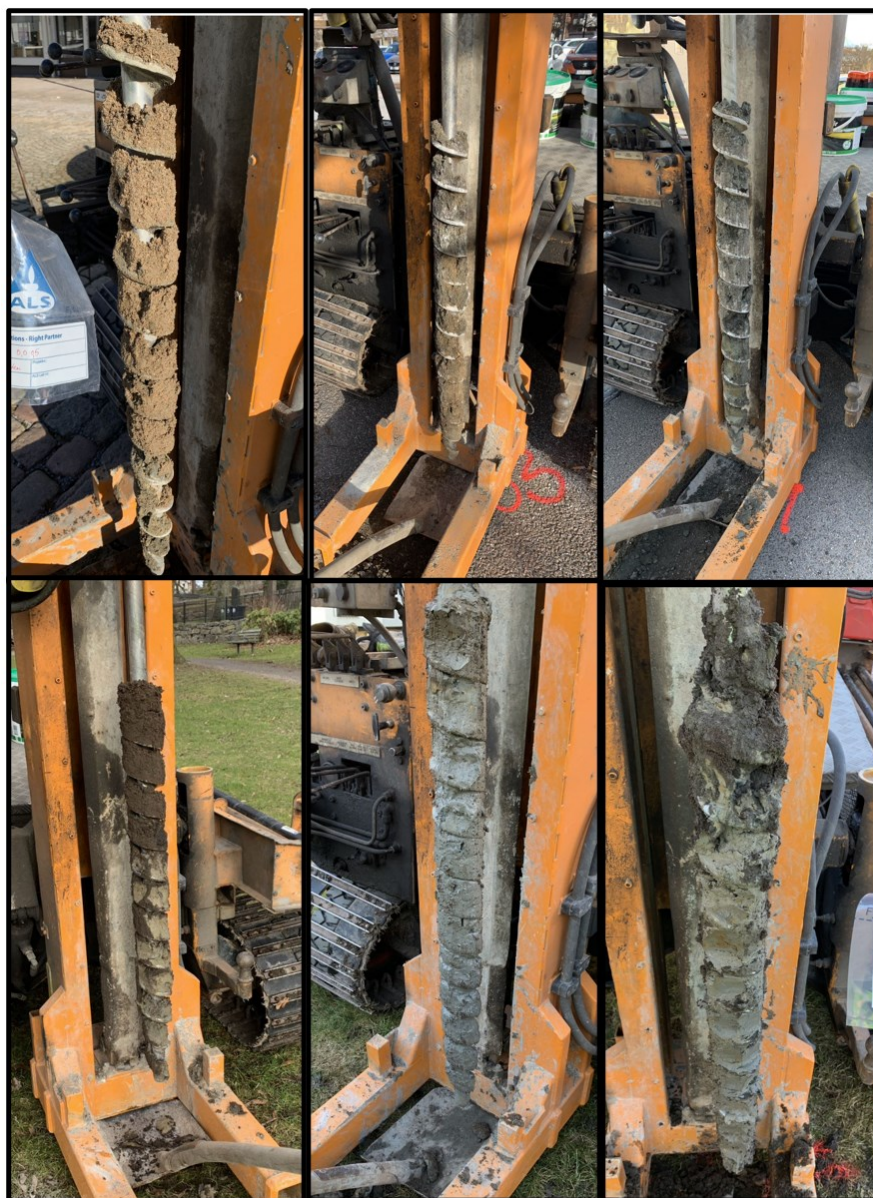
Figur 11. Exempel på fyllnadsmaterial (ovan) och jordarter (under) som påträffades inom undersökningsområdet.
