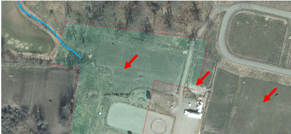
Bild 26. Norra delen har ett öppet dike (blå linje) som rinner in i planområdet som sedan är kuverterad under hagmark, röd pil visar dess läge.
