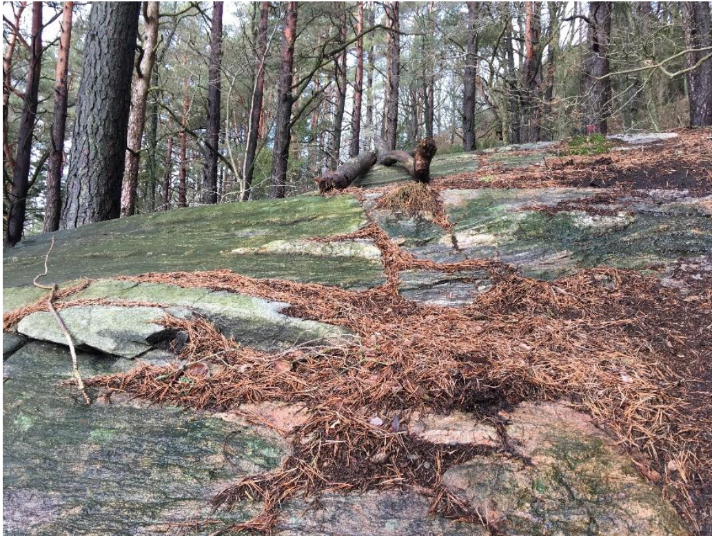
Figur 12. Kvarts- och fältspatrik, medelkornig, folierad gråvacka (rosa) i Storslätten. Sprickor är delvis jordfyllda, släta och plana.
