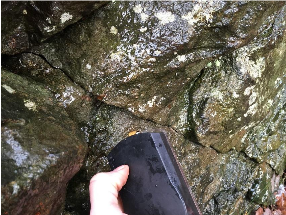
Figur 13. Delvis jordfyllda, släta och plana sprickor.
