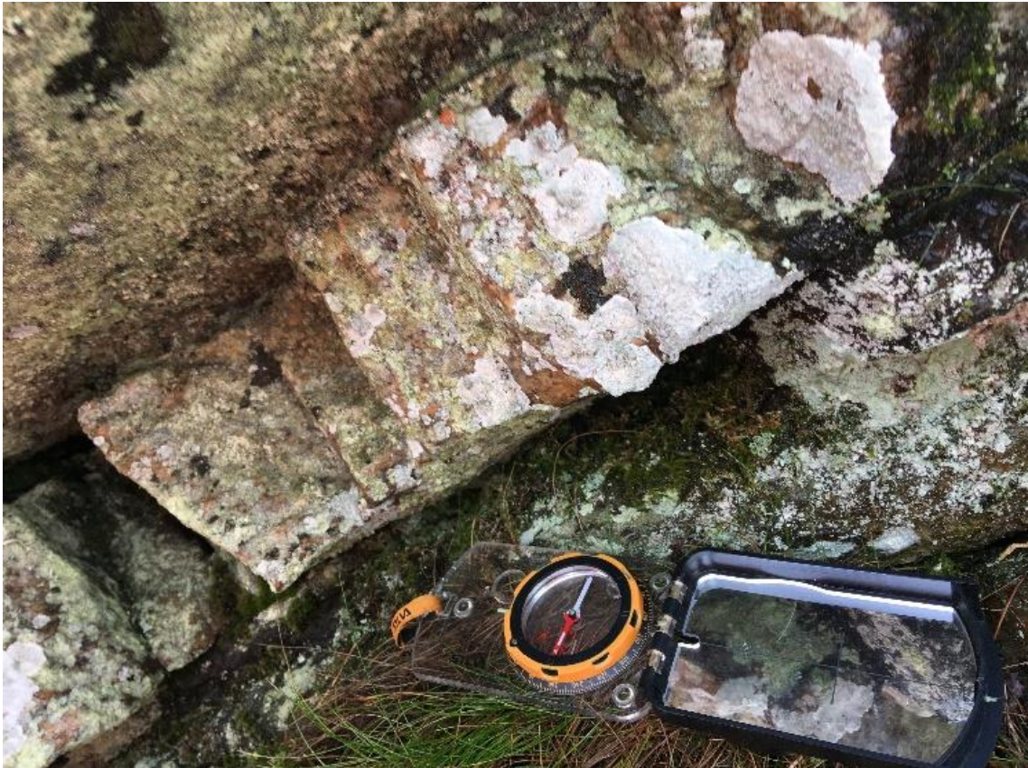
Figur 9. Delvis läkta sprickor med mörkt, hårt sprickfyllnadsmaterial, från plats 2.
