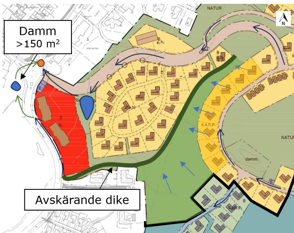
Figur 17. Inzoomad bild av avskärande dike i delavrinningsområde 1.
