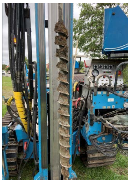
Figur 5. Leriga fyllnadsmassor 0-1 m, S1909.
