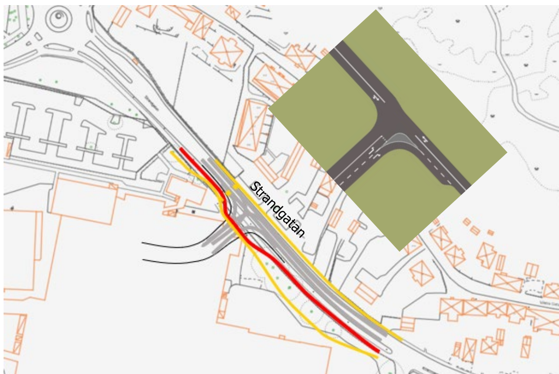
Figur 14 Möjlig principutformning av ny korsning med Strandgatan
