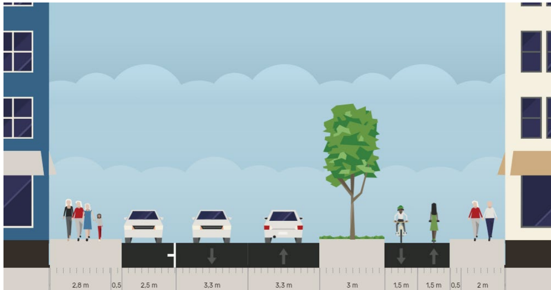
Figur 13 Möjlig typsektion på 21 meter bred gata genom Kexstaden.
