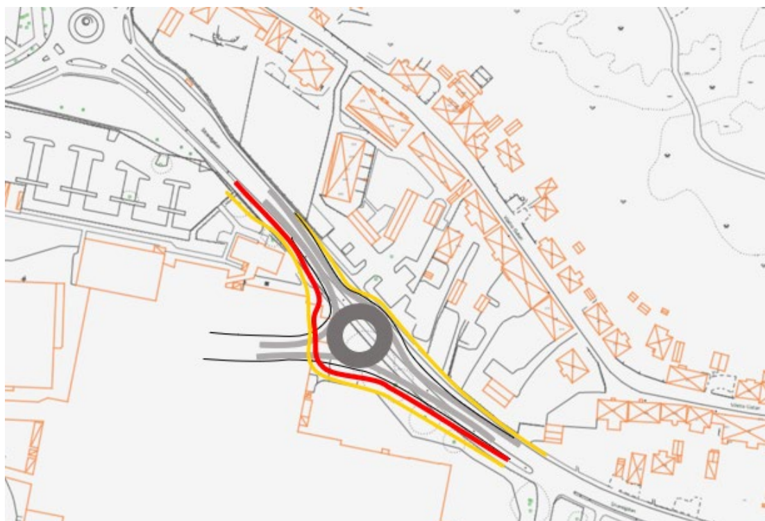
Figur 15 Möjlig principutformning av cirkulationsplats i ny korsning med Strandgatan
