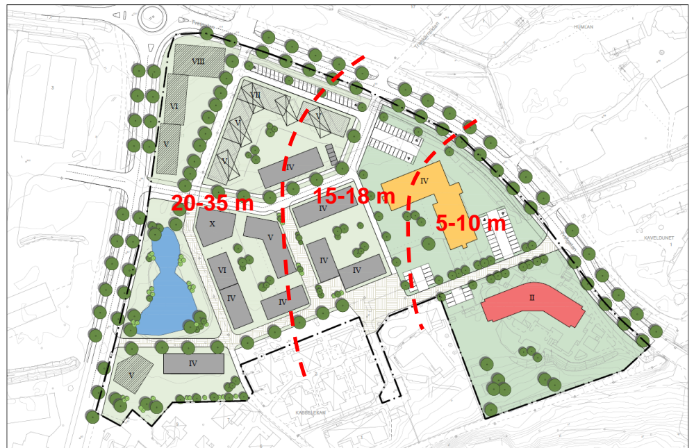
Figur 5. Planskiss med uppskattade pålängder utifrån lermäktighet.
