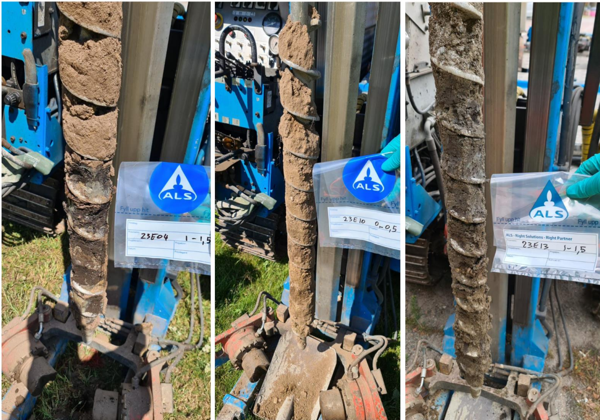
Figur 9. Foton som visar fyllnadsmassor som påträffades inom undersökningsområdet.
