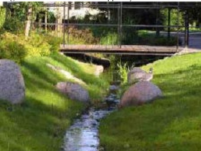
Figur 36 Våt dagvattendamm (SWECO, 2016)
