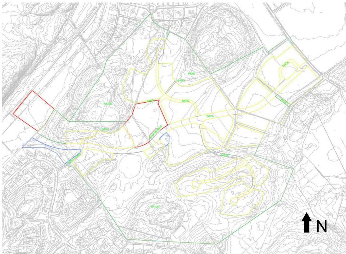
Figur 1 Översikt detaljplaneområde. Gul markering anger områden för vägar och bostäder, röd markering för skolor/förskolor, blå för infrastrukturella installationer och grön för naturområden. Ekvidistanslinjer har 0,5 m intervall.
