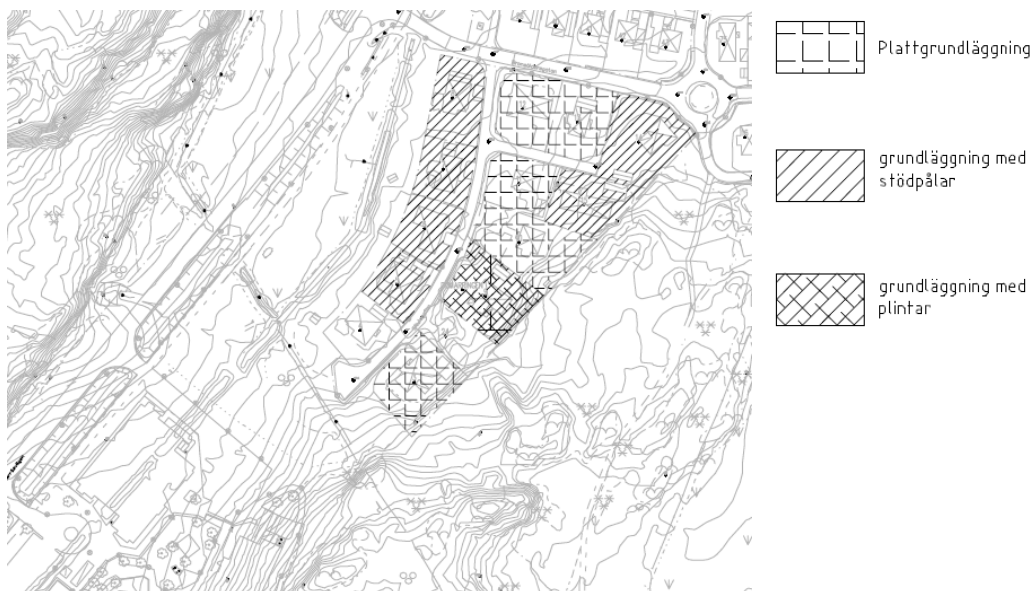
Figur 7. Inventering av grundläggning på närliggande villor.
