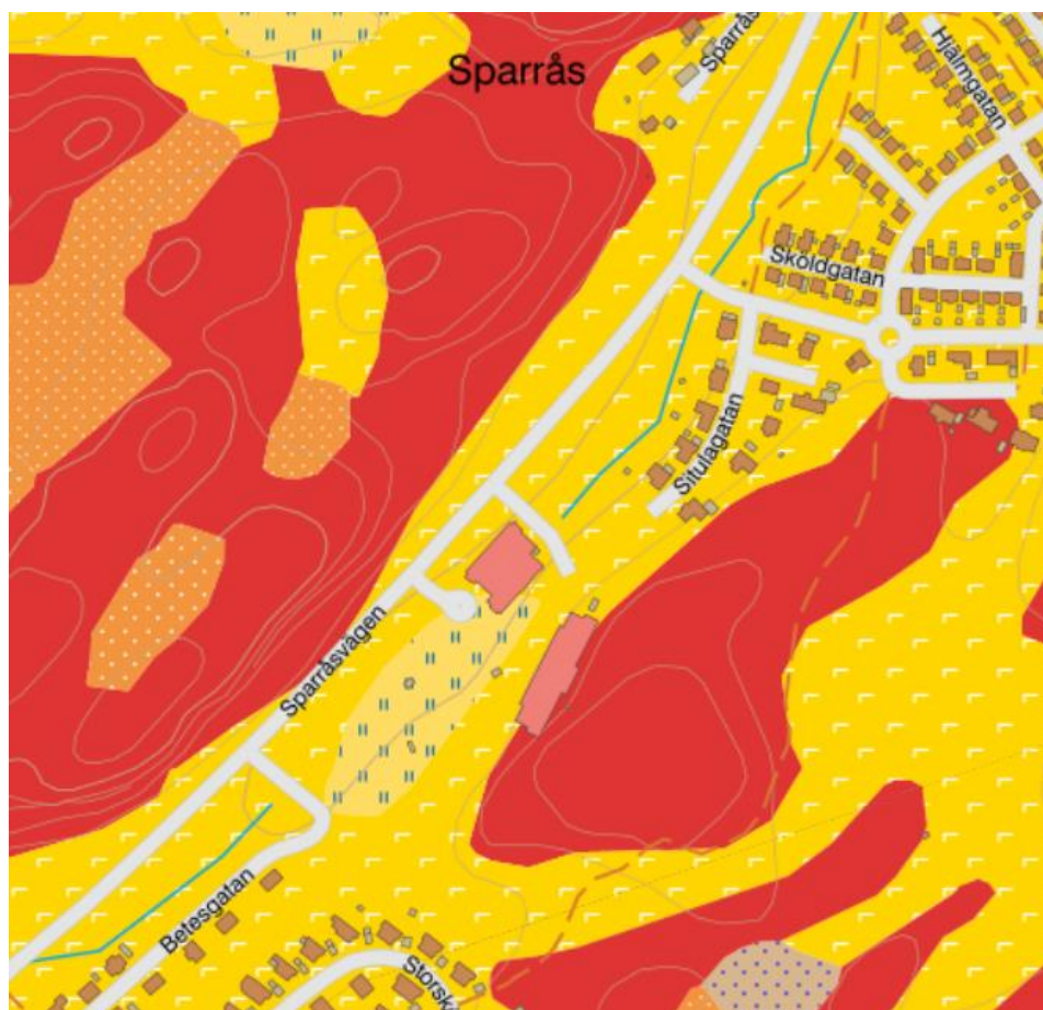
Figur 3. Klipp från SGU:s jordartskarta (2020-02-11). Rött är berg i dagen, orange är sand-grus och gult är postglacial lera. Precis söder om hallen finns även lite gyttja i markytan (ljusare gult). Dike ligger som blå linje och är kulveterad längs sträckan vid skolan och idrottshallen.
