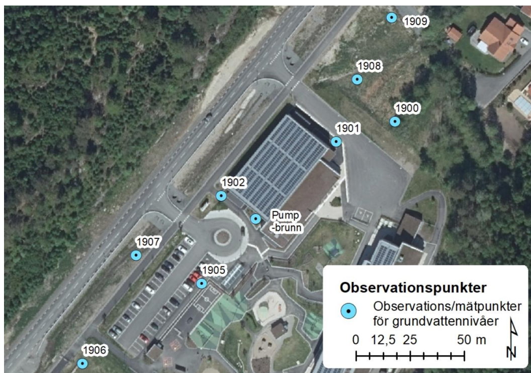
Figur 5. Placering grundvattenrör och nuvarande brunn som används för bortledning.
