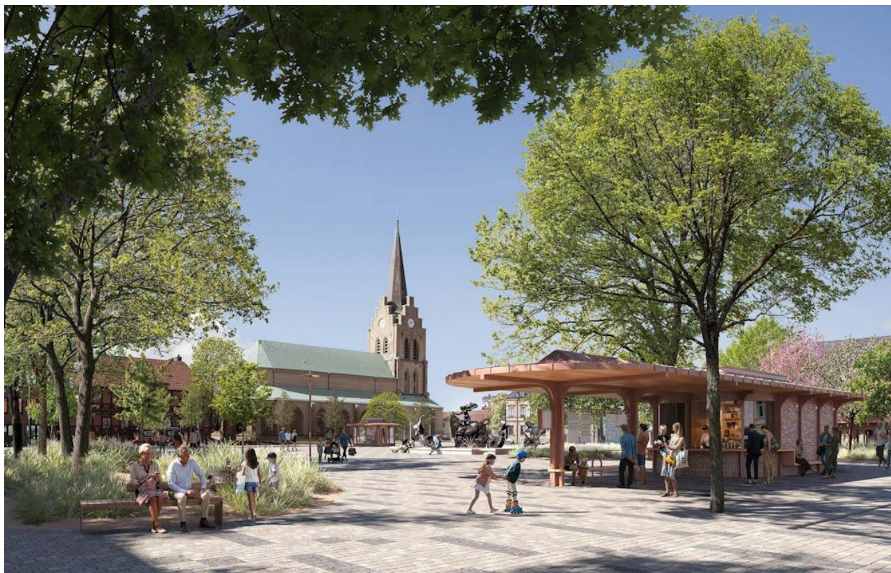
Figur 5:8-. På Stora torg i Halmstad har man integrerat en kombinerad växtbädd och skelettjord på torgytan för lokalt omhändertagande av dagvatten (Halmstad City, 2025)
