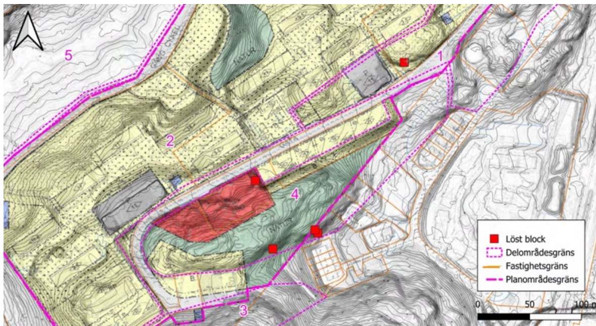
Figur 11. Löst sittande block, lokaliserade under bergteknisk utredning.
