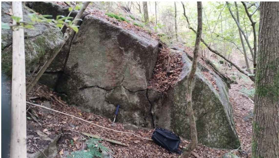
Figur 10. Foto mot nordväst med de tre tolkade sprickgrupperna synliga.
