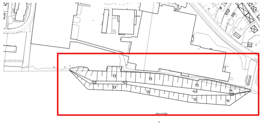
Karta som visar utförd tryckbank/erosionsskydd (Ramboll, 2021)
