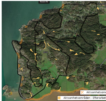
Urklipp ur Geotekniska utredningen. Identifierade riskområden för skred i finkornig jordart, Källa: PM Geoteknik/ Bergteknik, AWER 2023
