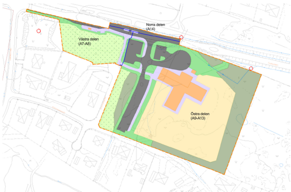
Figur 4. Framtida utformning efter exploatering indelat i delområden för dagvatten, släpppunkter markerade med röda cirklar.
