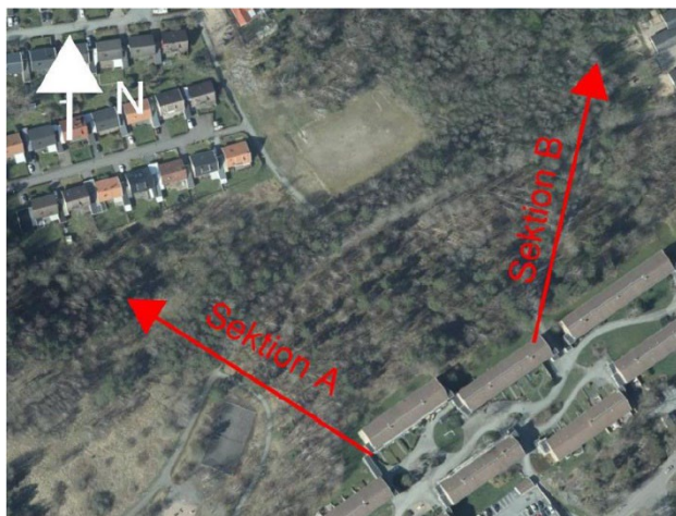
Figur 18. Sektioner för stabilitetsanalys, PM Geoteknik, COWI 2024.
